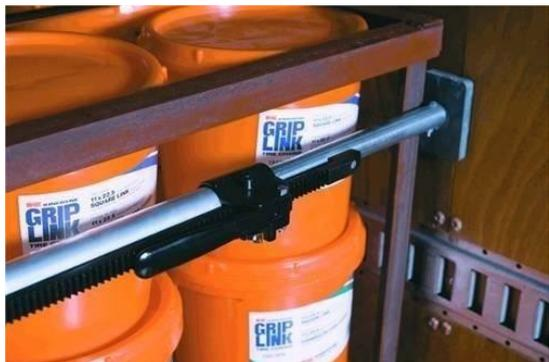
Este producto se coloca en forma horizontal de lado a lado en las paredes del tráiler o camión, se usa para sostener la carga y evitar el desplazamiento hacia adelante o hacia atrás de la caja del transporte. También conocidas como Gatas, tiene la forma de un cortinero de baño, pero de tubos de acero galvanizado que resisten 2 toneladas de peso en empuje, en sus extremos tienen tacones de fierro forrados con hule para mejor agarre y una cremallera de acero tipo gato mecánico para su ajuste.
